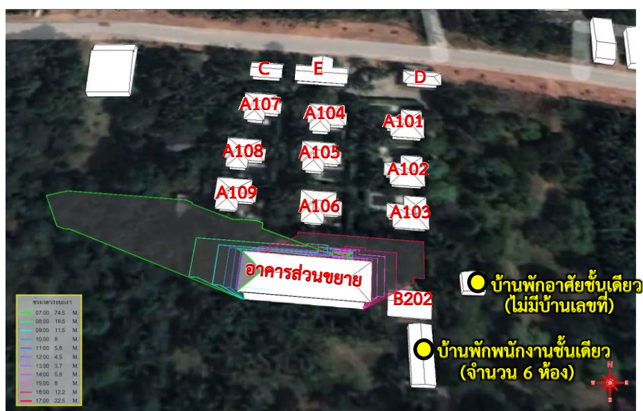
รูปที่ 4.3.8-9 แบบจำลองการบังแสงต่อพื้นที่ทุกชั่วโมงที่ทำการจำลอง วันที่ 21 เดือนธันวาคม
