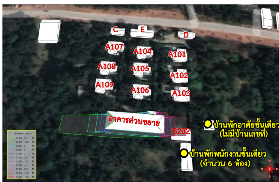
รูปที่ 4.3.8-7 แบบจำลองการบังแสงต่อพื้นที่ทุกชั่วโมงที่ทำการจำลอง วันที่ 21 เดือนกันยายน
